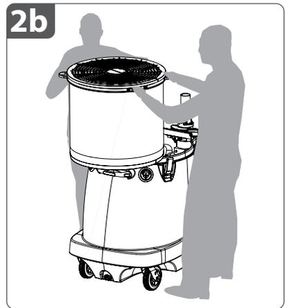
**2b.** Apoye el **cabezal del ventilador** con cuidado en el **borde del tanque** opuesto a la **vara de soporte del cabezal**, como se muestra.
